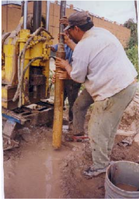
En la fotografía se observa el tubo de acero de pared delgada tipo Shelby para la obtención de muestras inalteradas.
