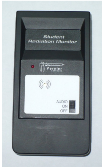
Figura 3.2. Monitor de radiación nuclear estudiantil marca National Instruments, Modelo SRM-BTD
