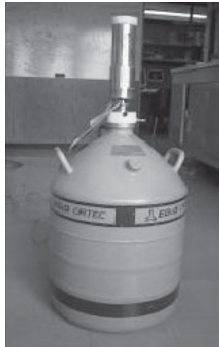
Figura 1.10. Detector de Germanio Hiperpuro con Dewar, de la Familia de los semiconductores .
