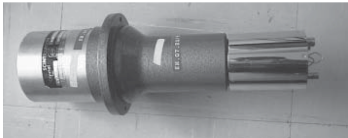
Figura 1.7. Los detectores de centelleo se utilizan en aplicaciones donde se requiere tener una gran sensibilidad de detección.
