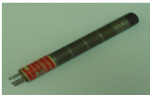
Figura 2.2. Detector Geiger-Muller Comercial (Cortesía Nuclear Chicago)
