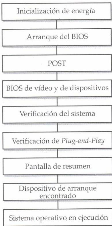
Figura 2-4. Pasos en el proceso de arranque del sistema.
