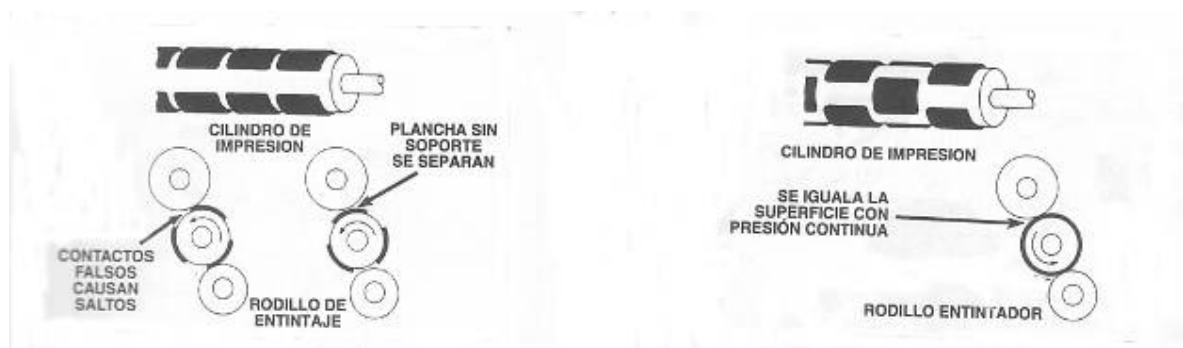
Figura 2.2.6. Montaje en fila incorrecto
