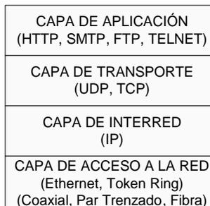
Figura 4.2 Variante de la Estructura del Modelo de Referencia TCP/IP.
