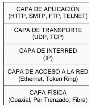
Figura 4.1. Estructura del Modelo de Referencia TCP/IP.
