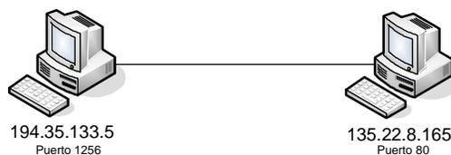
Figura 4.6. Transmisión entre dos computadoras tomando en cuenta dirección IP y puertos.
