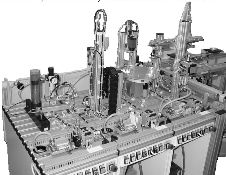
Fig. 3.51 Sistema Electroneumático Programable.
