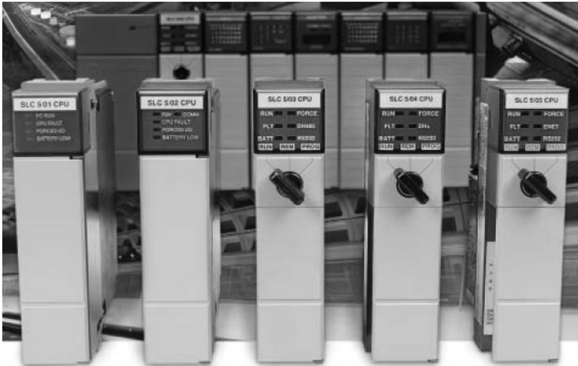
Fig. 4.59 Modelos del Sistema SLC-500 de Allen Bradley.
