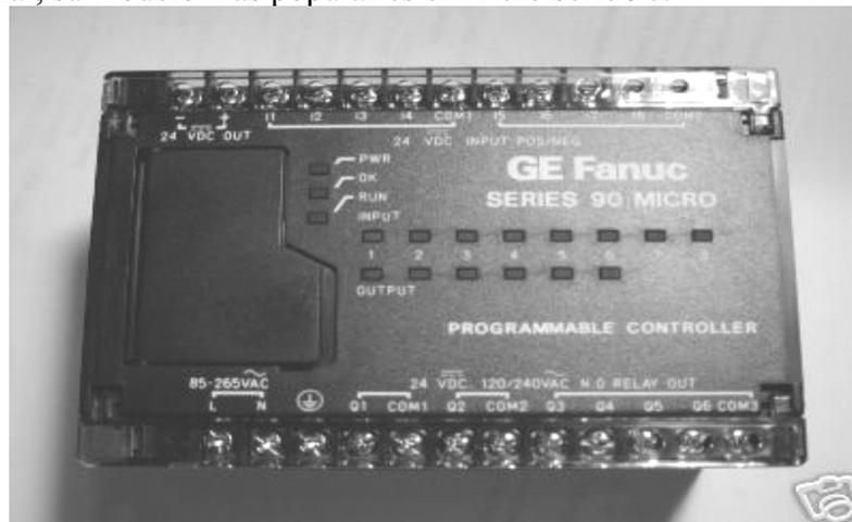
Fig. 4.11 Controlador Lógico Programable Serie Micro 90 GE-FANUC.
