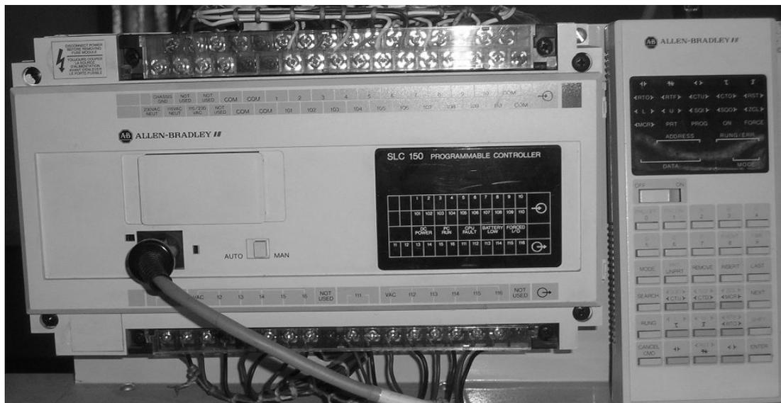
Fig. 4.7 Controlador Lógico Programable de Allen Bradley.
