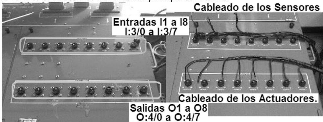
Fig. 6.4 Panel de Conexiones E/S del Entrenador.
