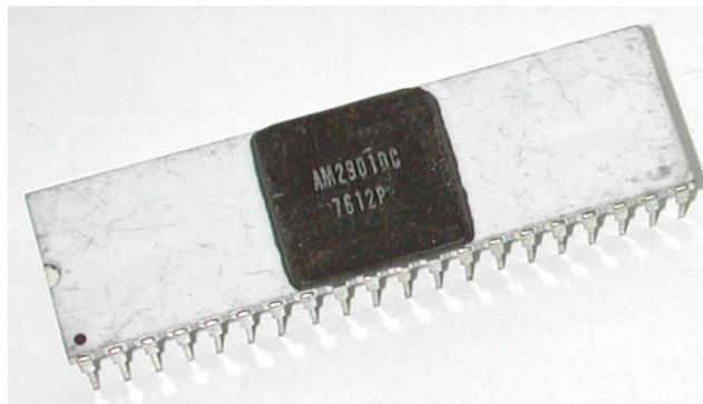
Fig. 4.5 Microprocesador AMD 2901.
