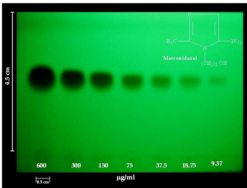
Fig. 27a. CCF del antibiótico metronidazol a diferentes concentraciones. La placa cromatográfica fue corrida con acetato de etilo-metanol (9/1) y estimulada a 365 nm.
