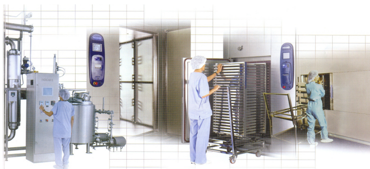
Figura 3.2.24 Equipo de vapor limpio, en acero inoxidable para áreas estériles
