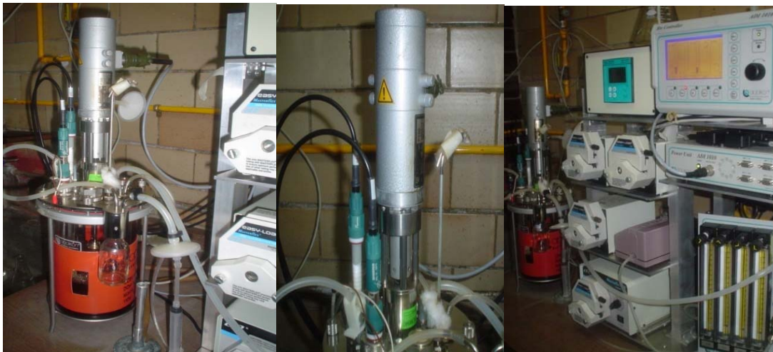
Figura 19. Imágenes del biorreactor empleado en las pruebas de biodegradación en la tercera etapa experimental.
