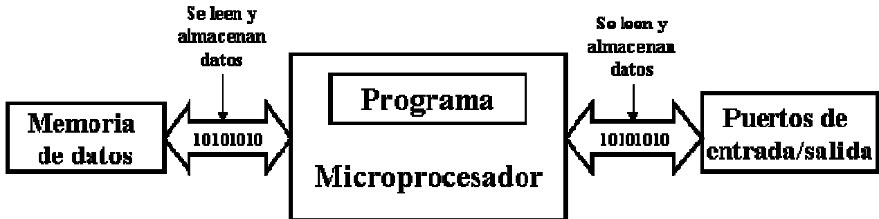
Figura B. Transferencia de datos en un sistema con microprocesador
