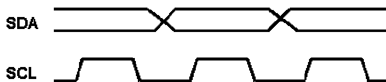
Figura 6.4. Transmisión de un bit por el bus I2C.
