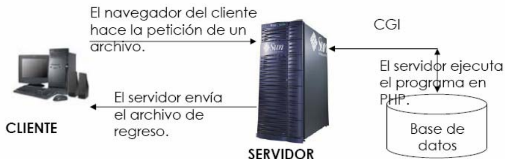
Figura No. 11. Diagrama de la comunicación Cliente-Servidor con PHP
