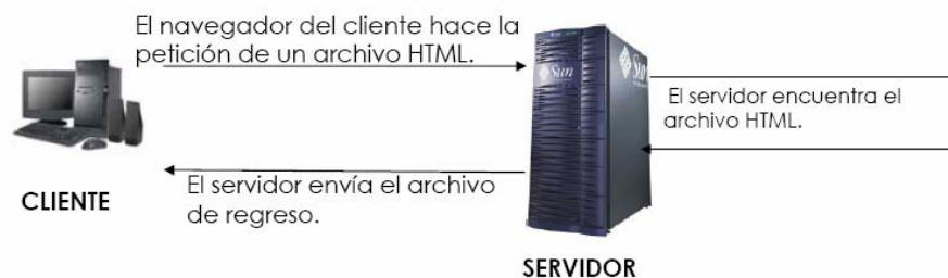
Figura No. 10. Diagrama de la comunicación Cliente-Servidor
