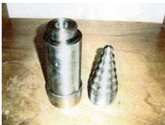
Figura 3.2 Vista de las dos partes que conforman el cabezal mezclador estático
