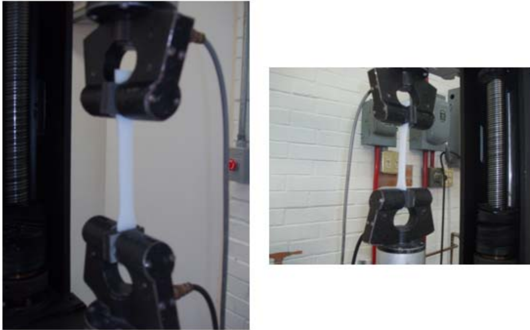
Figura 3.7 Ensayo de resistencia a la tensión
