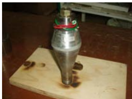
Figura 3.4 Transductor unido a pilar de acero inoxidable
