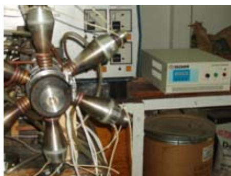
Figura 3.5 Vista final del cabezal mezclador estático modificado con la introducción de un sistema de aplicación de ultrasonido
