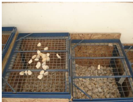
Figura 2.1 Cribado de grava.
