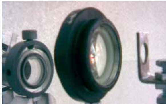
Figura 2.9. Componentes del sistema, de izquierda a derecha: cámara, lente convergente y soporte del detector de medición.
