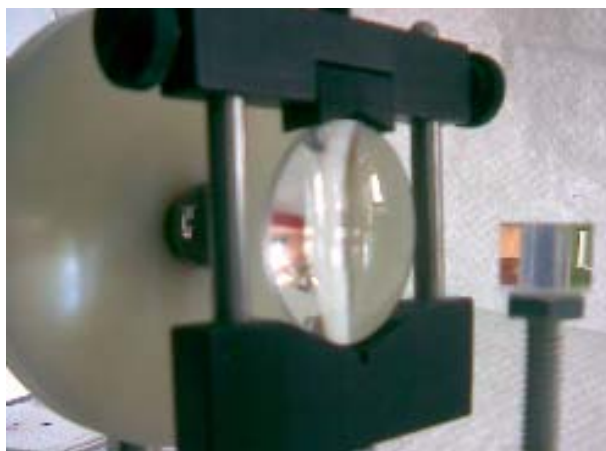
Figura 2.7. Componentes del sistema, de derecha a izquierda: cubo divisor de haz, lente convergente y sistema con polarizador y LED (al fondo).
