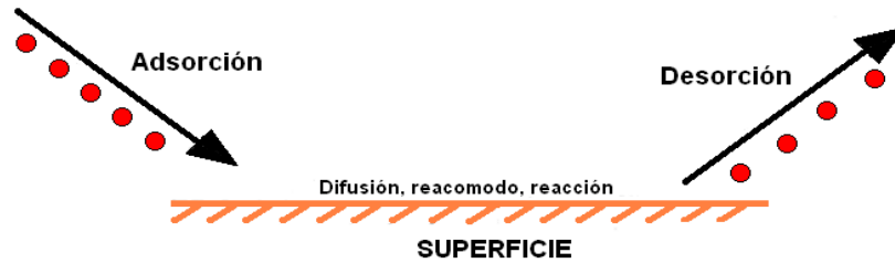
Figura 1.10. Esquema que ilustra los procesos elementales durante las interacciones gas-superficie.
