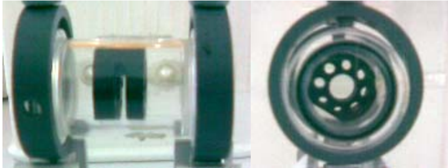
Figura 2.8. Cámara donde se pone en contacto el elemento sensor con el flujo de gas a detectar.
