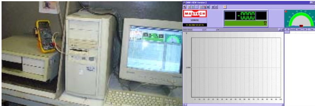
Figura 4.9. Aspecto exterior del sistema al realizarse una prueba y la ventana del “software” que nos permite la adquisición de los datos.
