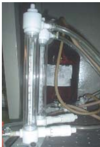
Figura 4.4. Medidores de flujo marca Gilmont Instruments.
