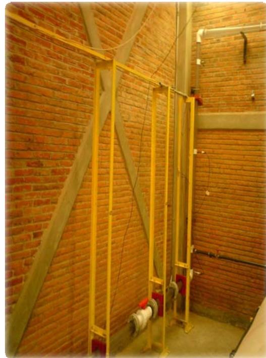
**Fig. 6.3** Tubería ascendente vertical (“riser”)
