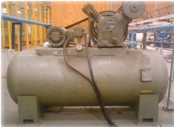
**Fig. 6.14** Equipo de compresión de aire
