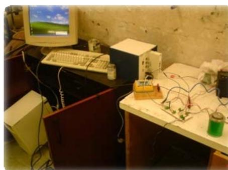
Fig. 6.6 Sistema de adquisición, cómputo y registro de gasto de líquido
