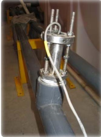
**Fig. 6.7** Sensor de flujo de alto rendimiento
