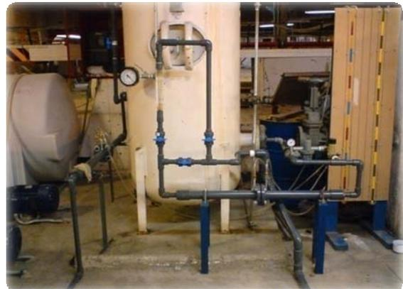
**Fig. 6.15** Equipo de medición de flujo de aire
