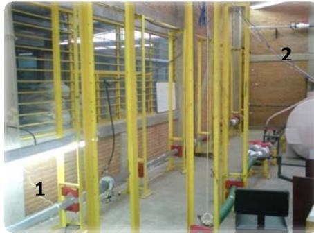
**Fig. 6.19** Secciones de estudio; 1) sección horizontal, 2) sección a la salida del “riser”
