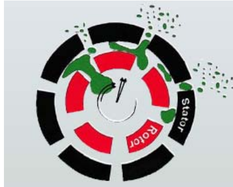
Figura 2.11 Principio de operación del homogenizador rotor estator (Madrid et al., 2001)
