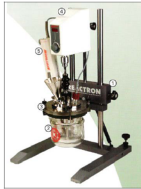
Figura 1.9 Equipo de pruebas de laboratorio en emulsiones Reactron
