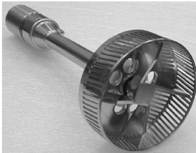
Figura 2.7 Homogenizador rotor estator, previo al nuevo diseño
