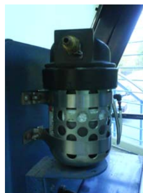
Figura III.2 Trampa de agua
