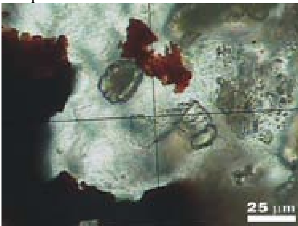
Figura 9. Cuarzo con hematita (rojo).
