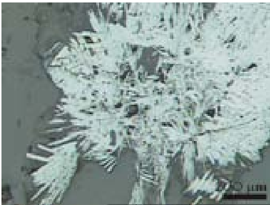
Figura 1. Hematita fibrosa con luz reflejada.
