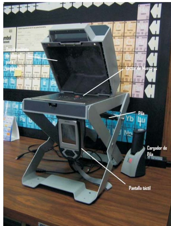
Fig. 4.9 Espectrómetro de Fluorescencia Portátil de Rayos X (FPXRF) (Instituto de Geología, UNAM).
