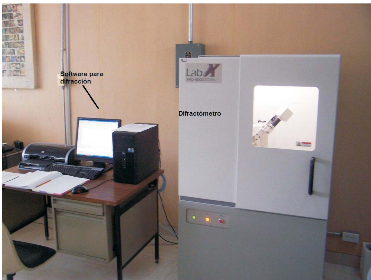
Fig. 4.8. Equipo de Difracción de Rayos X (Instituto de Geología, UNAM).
