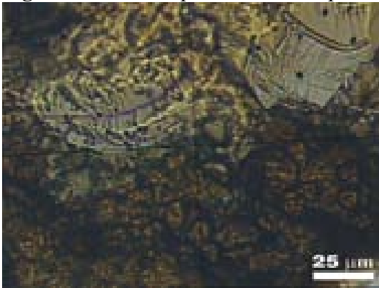
Figura 7. Reflexiones internas de la esfalerita con luz transmitida.
