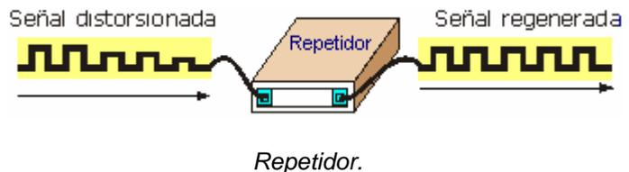
Un repetidor funciona en el nivel físico del modelo de referencia OSI para regenerar las señales de la red y reenviarla a otros segmentos.
