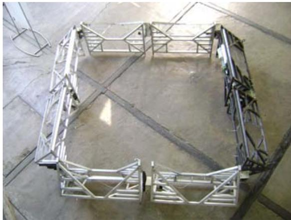
**Figura 5.1** Escultura en forma de ventana para verificar interferencias mecánicas.
