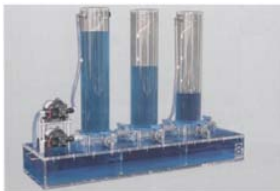
Figura 3-1: Sistema de tanques AMIRA DTS200
