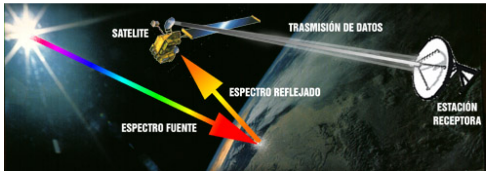
Figura 2.9 Esquema operativo de un satélite de observación
