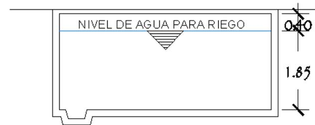
IMAGEN No. 9 Dibujo esquemático de la Cisterna del Sistema de Riego
