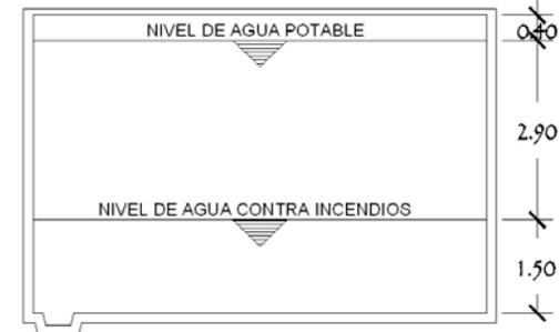
IMAGEN No. 7 Corte esquemático de la cisterna.
