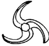
*Fig. 2.16 Impulsor Abierto*
