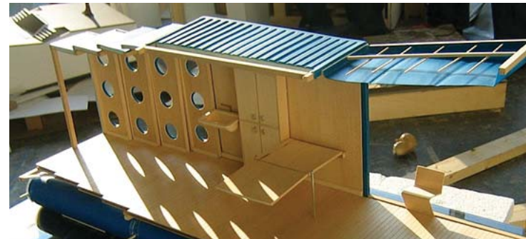
Fig.21. The Shrimp, es una casa sustentable para refugiados, para producir masivamente, pensada para cuatro personas, con dimensiones necesarias para facilitar su transportación. Esta vivienda está pensada que en caso de difícil accesibilidad por desbordamientos de río o exista agua de por medio, en su base, tiene un sistema de boyas que permiten que flote y se pueda desplazar al lugar requerido.
