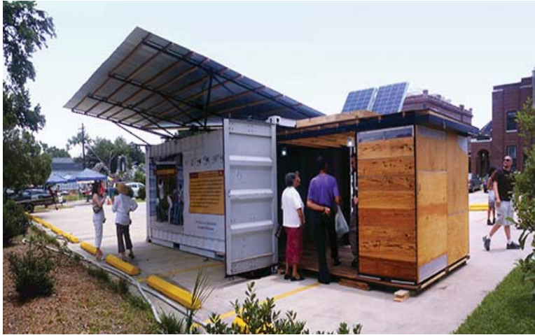
Fig.18. The Clean Hub, diseñado por John Dwyer, con la idea de diseñar una vivienda de fácil transportación en poco tiempo y de poco mantenimiento con una estructura resistente, proporciona a sus habitantes la atención de necesidades básicas como agua, alimentación, seguridad funcionando con energía solar, reciclamiento de agua y una composta. Estas unidades fueron utilizadas después del huracán Katrina en E.U.A.
