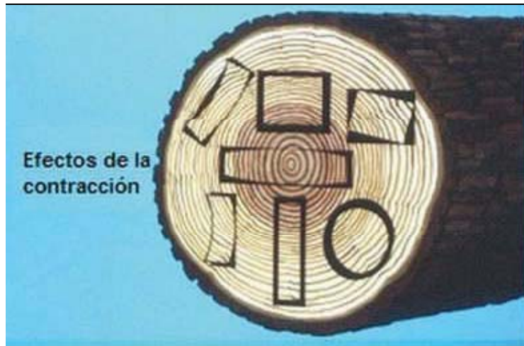
Figura 1-28: Efectos de la contracción en la madera.
