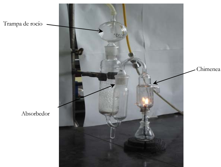
Figura 2.1 Dispositivo utilizada para la combustión de gasolina de alquilación mediante el “Método de Schöniger” [90]
