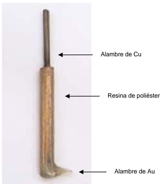
Figura 2.10 Especimen de la FCP fabricado en laboratorio.
