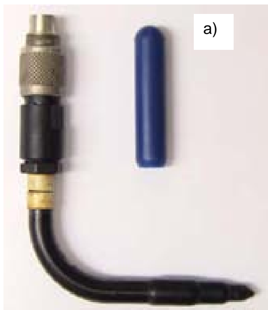
Figura 2.3 a) La probeta diferencial del SRET con electrodos de platino en el fondo a la derecha. b) Arreglo de las puntas platino de la probeta del SRET utilizada en el presente estudio. La figura b) no está a escala.
