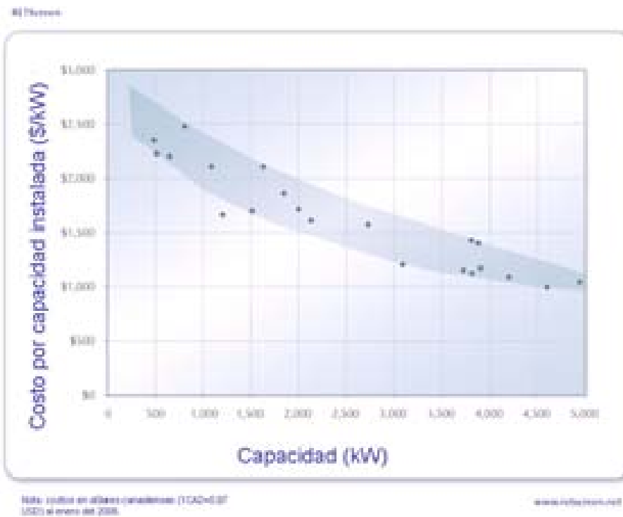
Gráfica 4.5 Costos de equipo e instalación de turbinas de gas (5 a 50 MWH)
