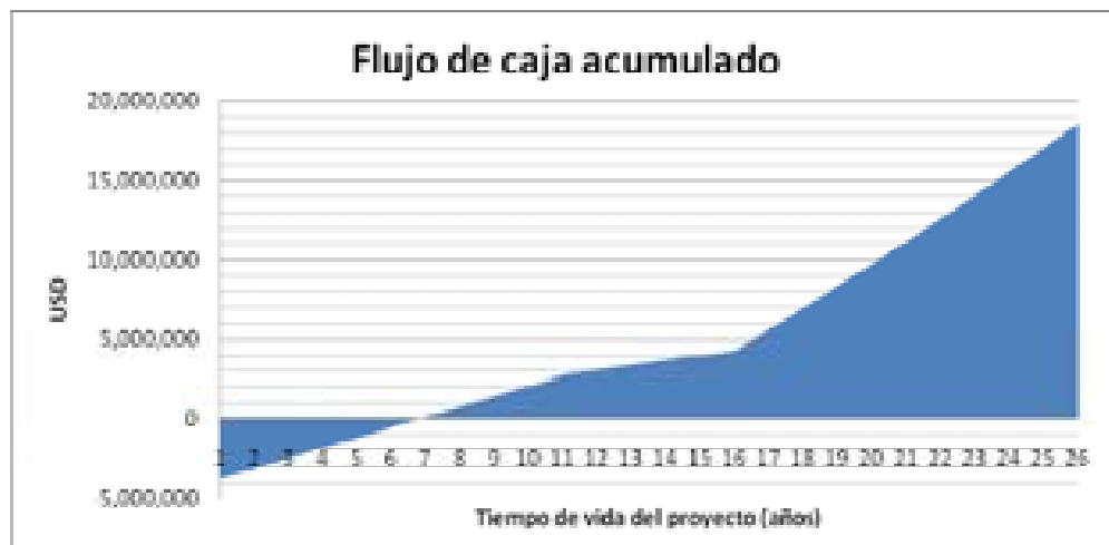
Gráfica 4.6 Flujo de capital acumulado para el proyecto de aprovechamiento energético del biogás con motor recíproco, en el Relleno Querétaro
