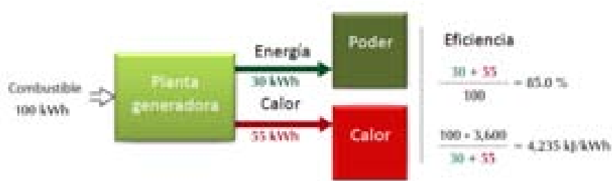
Figura 3.14 Cálculo de eficiencia al convertir calor en energía
