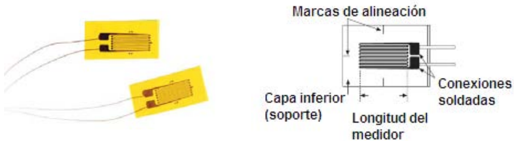
Figura 3.3 a) Galgas extensiométricas típicas (uniaxial), b) construcción esquemática de una galga uniaxial.
