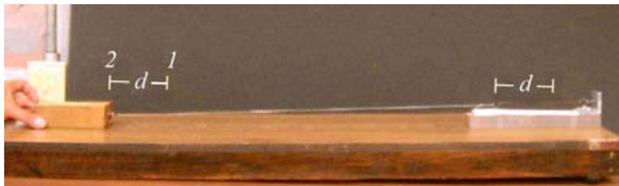
Figura 2.3 (d) Deformación, (1) Posición inicial del bloque, (2) Posición intermedia del bloque.
