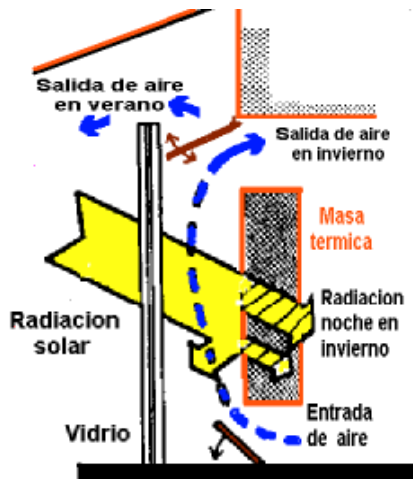
Imagen No. 41. Muro Trombe. http://php.aperitivoillustrato.it/n12/trombe.jpg
