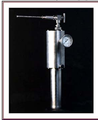
Figura 2.5 Calorímetro Ellison con Termopar para medir la temperatura.
