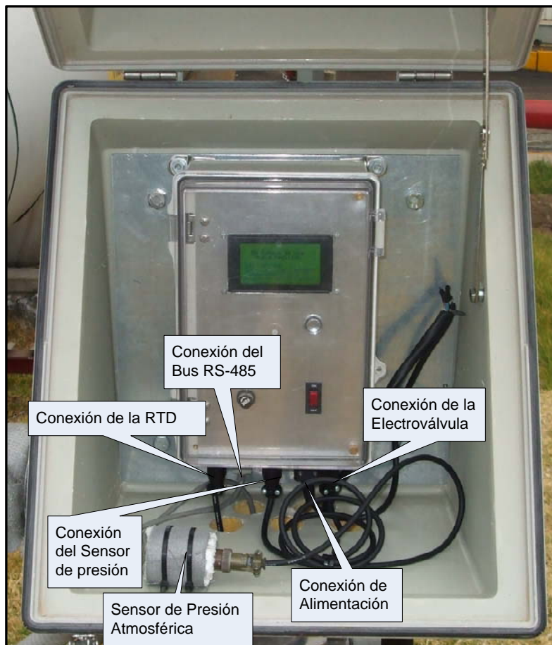
Figura 4.15 Sensor de presión atmosférica y la Conexión de Elementos al SEC.
