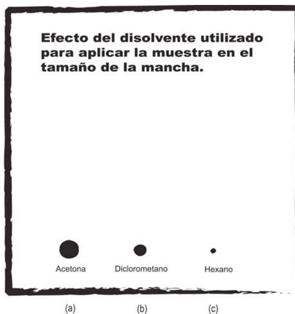
Fig. 3.4 Polaridad del disolvente utilizado para colocar la muestra y tamaño de mancha en TLC de fase normal
