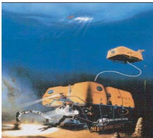
Una de las cualidades que se tienen los ROV de trabajo es que pueden alcanzar grandes profundidades, como es el caso de el ROV de la foto superior “KAIKO” que fue remodelado para alcanzar profundidades de 7000 m. este ROV esta dividido en 2 partes: lanzador y vehículo.
