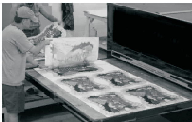
IMAGEN 138 El transfer es un procedimiento nuevo que tiene la ventaja de ser más rápido que la serigrafía.
