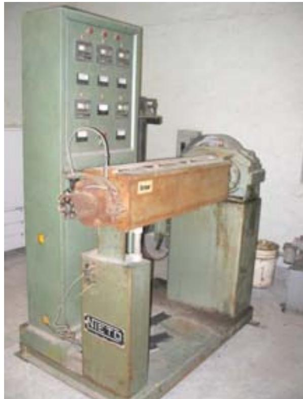
*Figura 3.1. Imagen del extrusor marca NIETO al momento de llegar al Laboratorio de Procesamiento de Plásticos de la FI.*
