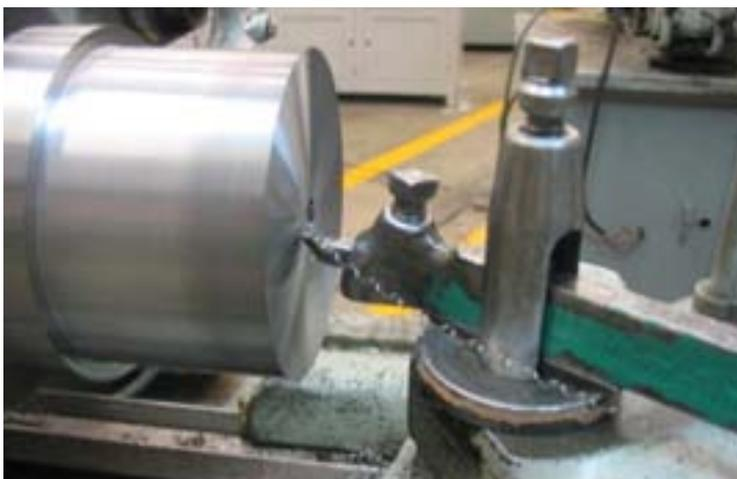
*Figura 5.8. Proceso de desbaste en torno utilizando buriles con inserto de carburo de tungsteno. La pieza que se muestra es el soporte en su primera etapa de desbaste.*
