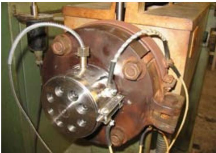
*Figura 5.12. Dado montado en la máquina*
