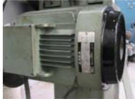
Figura 3.4. Motor del extrusor.
