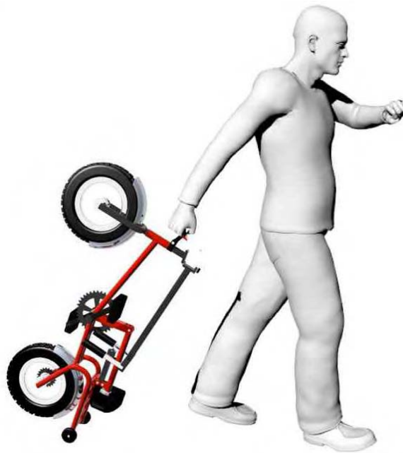
Figura 5.12 - Modo en que la bicicleta puede ser trasladada por el usuario con facilidad
