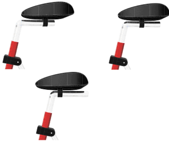
Figura 5.6 – Ajuste horizontal de asiento
