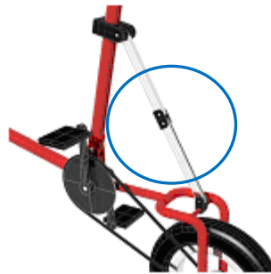
Figura 5.4- Barra de soporte del asiento
