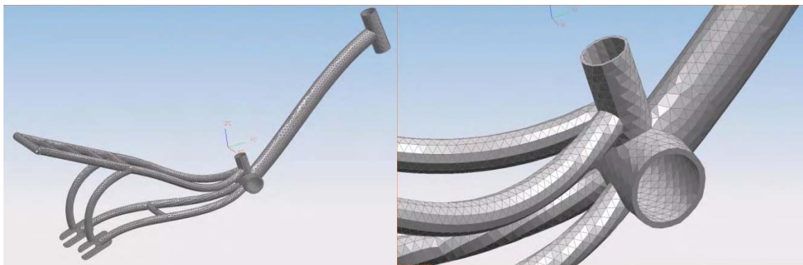
Figura 5.21 - Representación del mallado del cuadro.
