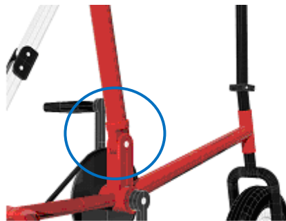
Figura 5.5- Rotación del poste de asiento
