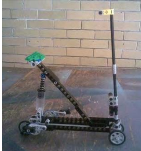
Figura 4.11 - Modelo del diseño conceptual, construido para mostrar la apariencia y secuencia de plegado de la bicicleta.
