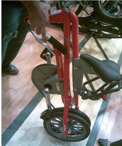
Figura 4.6- Ruedas de arrastre ubicadas a la mitad del ancho de la bicicleta.
