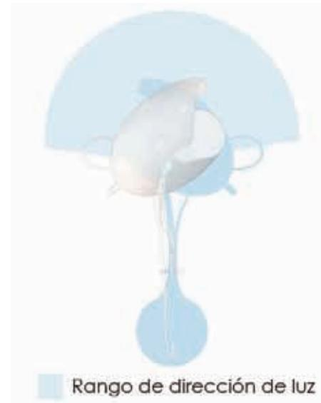
Obtiene energía de cajas de luz instaladas en la pared, por lo que hay que tomar en cuenta que se debe tener una instalación previa. Para facilitar su encendido, tiene una perilla integrada a la pantalla. Al igual que en la luminaria de piso, el cable sale por la parte inferior trasera, por una perforación que se remata con un pasacables.
