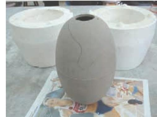
7. Una vez hechos los cortes y perforaciones, se pasa sobre la superficie de la pieza una esponja húmeda y se pone a secar para eliminar la humedad por completo, dejando la pieza lista para la primera quema o sancocho.
