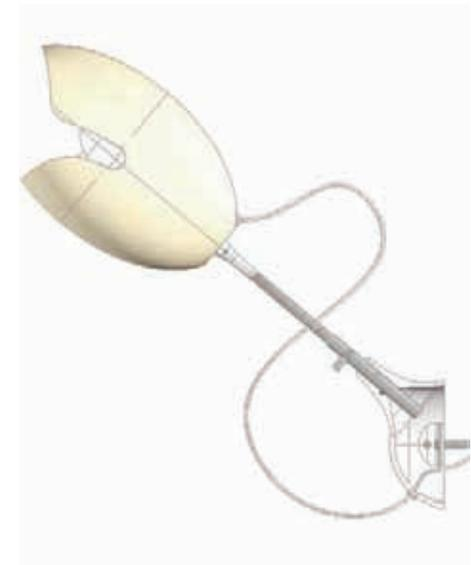
El ensamble entre el soporte de pared (S-pa) y la base de pared se logra insertando el soporte de pared en la base de pared y se aseguran ambas piezas con un perno.
