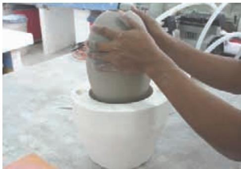
6. La pieza sale del molde con una línea y unos huecos marcados, los cuales sirven de guía para hacer el corte y las perforaciones que debe tener la pieza manualmente con herramientas.
