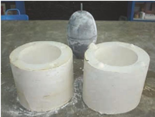
2. El molde de yeso se cierra, se colocan unas bandas elásticas para evitar que se abra y se procede a vertir en él la pasta en estado líquido, que se conoce como barbotina.
