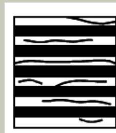
Agrietamiento de la matriz.
