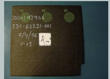
Muestra A (cara anterior) con daño correspondiente al impactador #1, 2 y 3.
