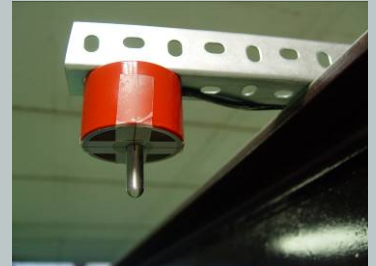
Impactador #1 sujeto al electroimán.
