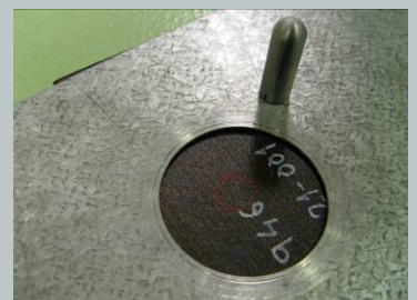
Daño aplicado en la muestra A con el impactador #3.
