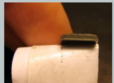
Muestra A. Foto para medir el espesor de las capas.
