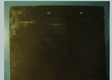
Muestra A (cara posterior) con daño correspondiente al impactador #3, 2 y 1.
