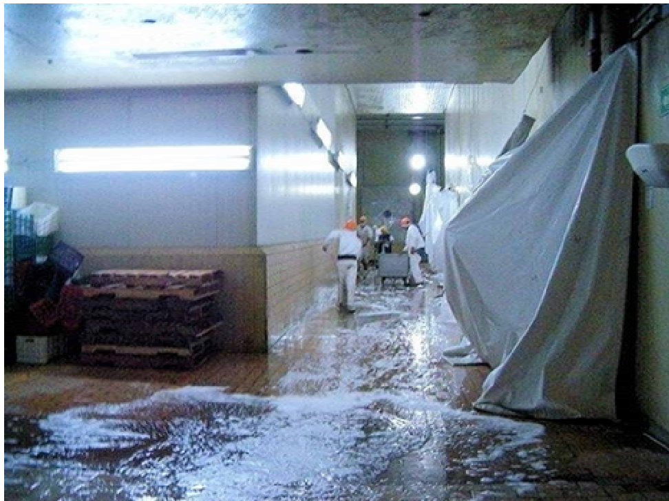
Foto 25. Limpieza de área de trabajo, con el uso de agua potable, detergente y espumas sin sosa, aprobados por la FDA
