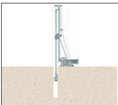
Figura III.2 Perforación de Pilas.
