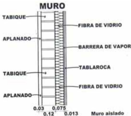
F.126. Detalle constructivo de muros intervenidos con aislamiento térmico (arriba) y modelo en isométrico (abajo). Fachada sur y norte.
