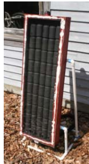
Fig. 82. Fabricación casera de un colector solar de aire sin vidrio empleando latas de refresco
