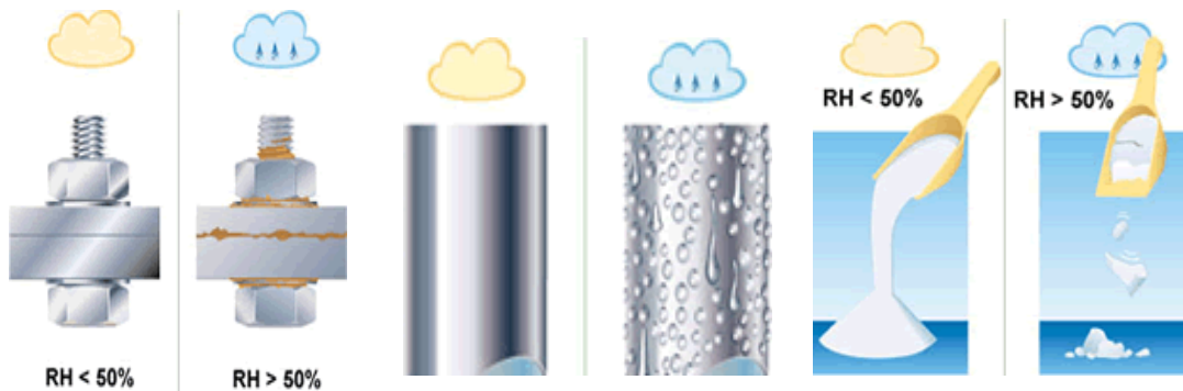
Fig. 86. Efectos de la humedad en materiales cuando RH (humedad relativa) <50% y >50%, de izquierda a derecha: corrosión, condensación y absorción de humedad en materiales de cualidades higroscópicas.
