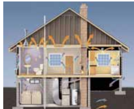
Fig. 88. Infiltraciones en una vivienda
