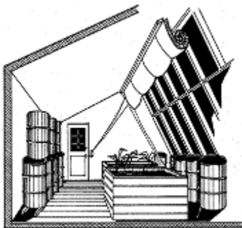
Fig. 90. Tanques de agua para almacenar calor en un invernadero adosado.
