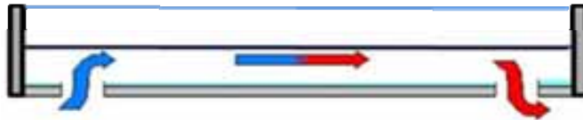
F.26. Colector de placa intermedia. Sitiosolar. La calefacción solar por colectores de aire. http://www.sitiosolar.com .
