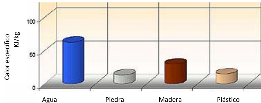
F.35. Gráfica de calor específico del agua, piedra, madera y plástico. www.rubitherm.com
