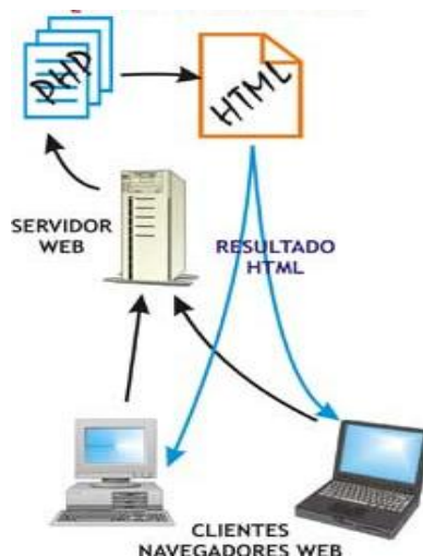
Figura 2.5.1 Ejecución de PHP
