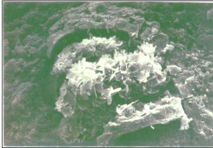
Figura II.2. Fotografía mostrando la matriz arcillosa (plaquetas de clorita) de las rocas de la Cuenca de Chicontepec (Tomada de Pemex, 2005).
