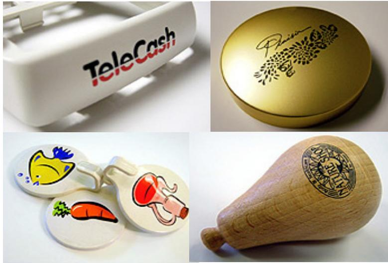
La tampografía es una de las técnicas más usada para impresión sobre superficies pequeñas y especialmente para aquellas superficies no lisas y que suponen cierta dificultad. Las imágenes son transferidas a los objetos a través de un tampón (almohadilla de silicón) que recoge la tinta de un cliché en bajorelieve, estas tintas son diferentes a las utilizadas en serigrafía. Ventajas y desventajas:
