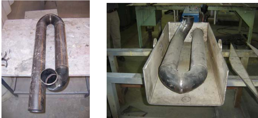
Figura 4.15 a) Tubo soldado para la cámara de combustión y b) acoplamiento del tubo a la cámara de combustión.
