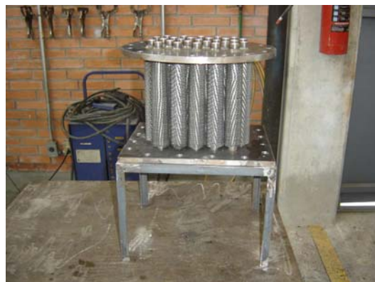
Figura 4.16 Sección de convección (tubos aletados).
