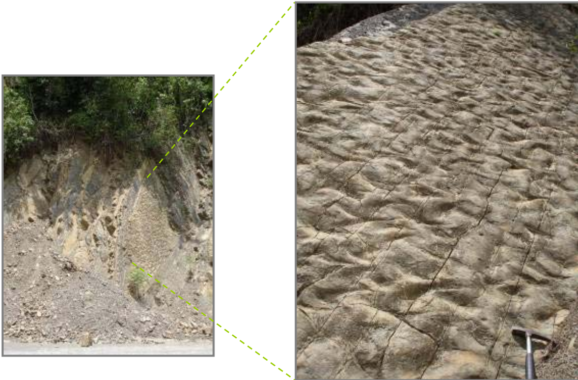
Fig. 4.4.3. Irregularidades u ondulaciones sobre la superficie de estratificación de las areniscas, producto de la compactación diferencial de los estratos durante su sepultamiento. El martillo tiene una longitud de 31.8 cm.
