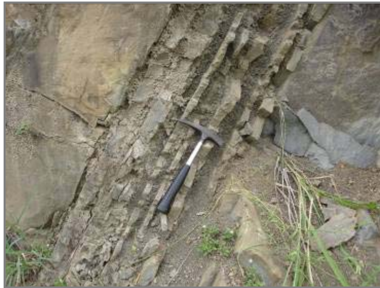
Fig. 4.1.10. Alternancia de areniscas con estratificación delgada y limonitas-lutitas. El martillo tiene una longitud de 31.8 cm.
