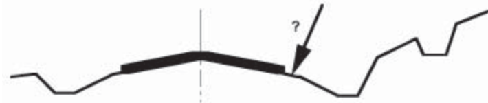
Figura 67. Diagrama de una berma.
