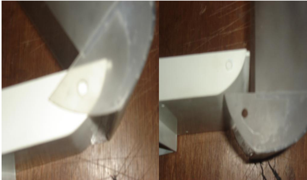
Figura 56. Unión del contenedor de botones con la tapa de la impresora.
