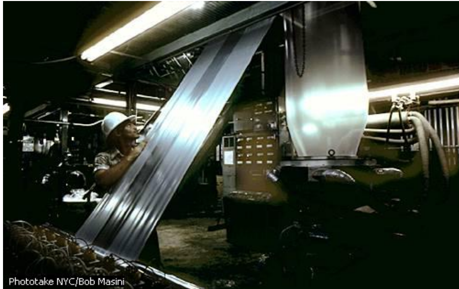
Figura 20. En el calandrado, el plástico pasa por una serie de Rodillos de calientes y se transforma en láminas finas. Posteriormente para ala maquina de moldeo por soplado. Phototake NYC/Bob Masini.
