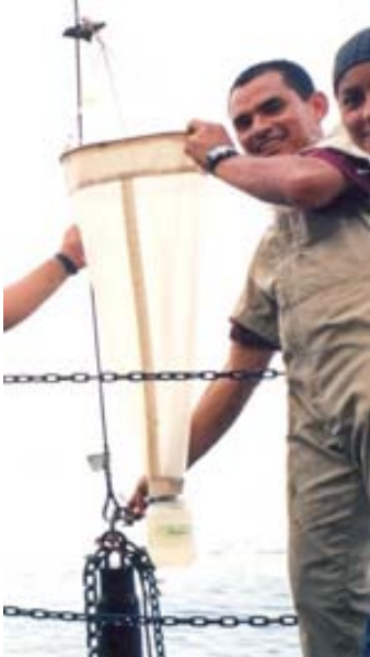
Red de fitoplancton de 64 \mu\text{m} de malla con Frasco colector, preparada para el arrastre vertical de 100m de profundidad, sujeta a un cable metálico.
