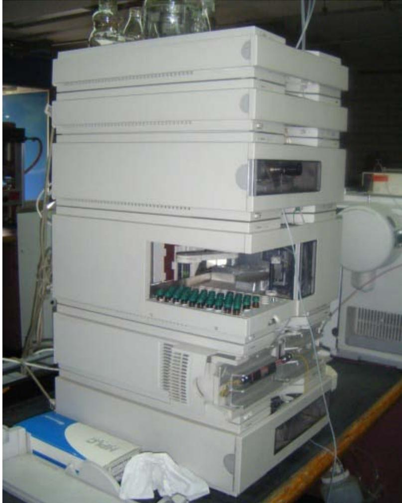
**Figura 7.** Cromatógrafo de Líquidos utilizado durante la etapa experimental
