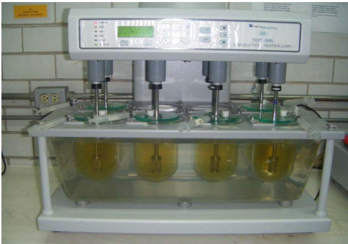
**Figura 4.** Equipo disolutor utilizado durante el desarrollo experimental
